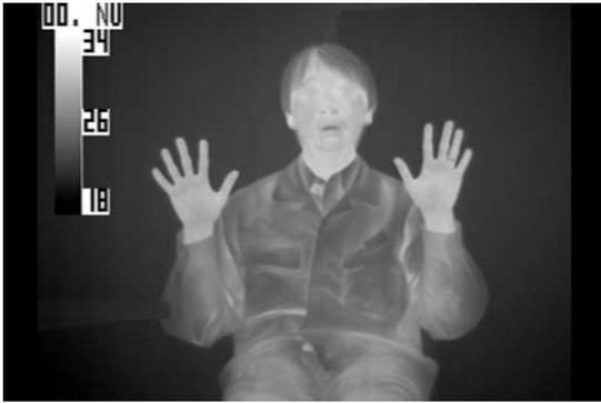
写真4 遠赤外線カメラを用いた絶対温度計測
