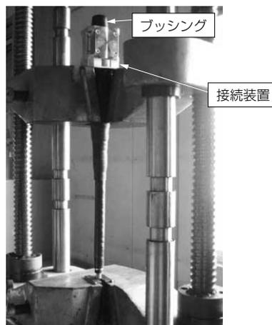
写真6 接続装置の引張り試験
