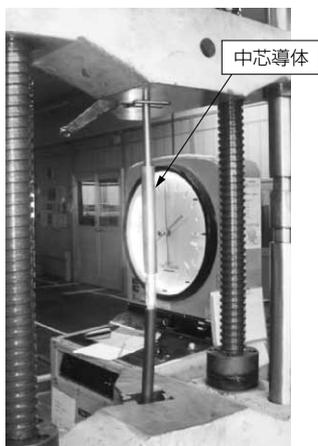
写真5 中芯導体の引張り試験
