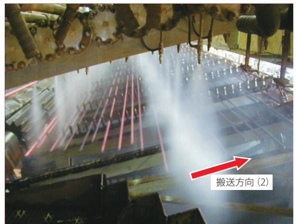
写真1 鋼棒ミスト冷却装置外観
