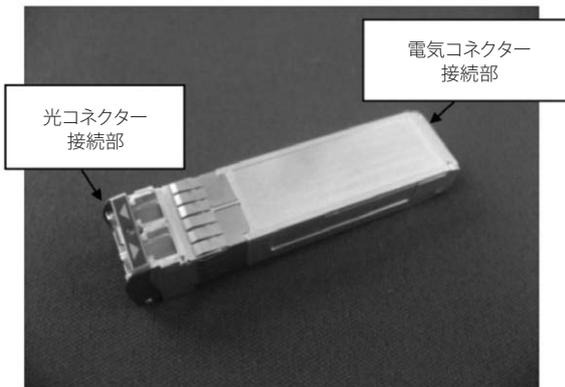
図1 光トランシーバー “SFP+” の外観
