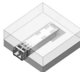
図6 金属のパッケージで囲われた光トランシーバ
