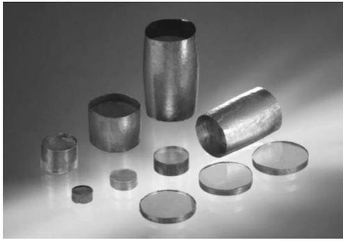
写真1 超高压高温下での直接変換により得られた高硬度ナノ多結晶ダイヤモンド
