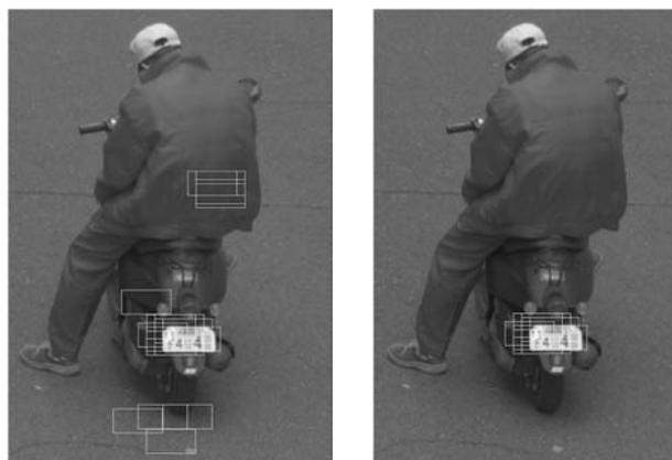
写真4 ナンバープレート検出結果の例。車両周りを拡大して表示。左はエッジ分布によるスクリーニングを行わない場合、右はエッジ分布によるスクリーニングを行った場合。画像は一部加工済み
