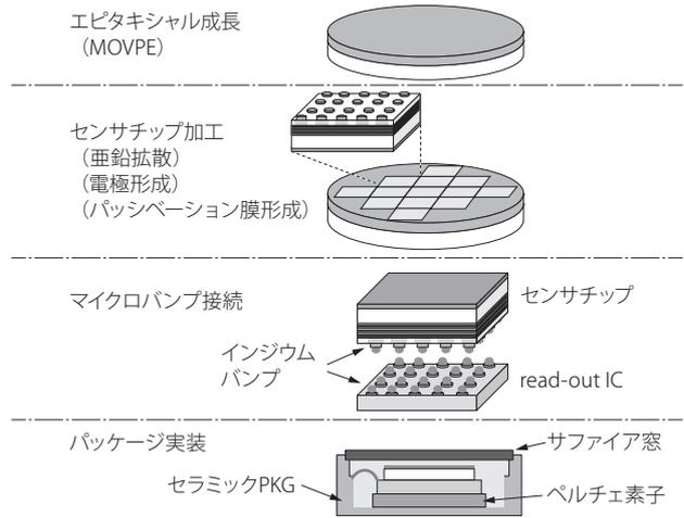
図2 センサの製造フロー
