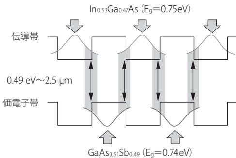
図1 InGaAs/GaAsSbタイプII量子井戸のバンド構造 (層厚5 nm/5 nmの場合)
