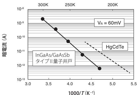
図3 InGaAs/GaAsSb タイプ II 量子井戸型センサと HgCdTe センサの暗電流の温度依存性
