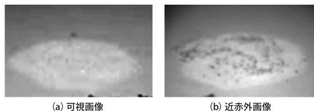
写真3 塩と砂糖の混合物の可視画像と近赤外画像。
