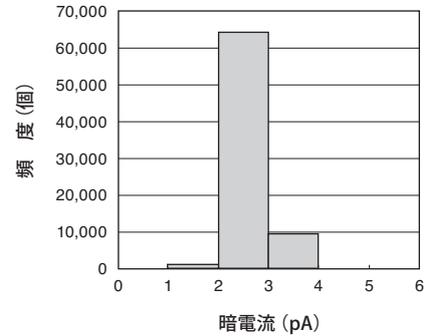
図4  $320 \times 256$  画素面内の暗電流ヒストグラム  $V_R=1.2\text{V}$ 、 $T=213\text{K}$  で測定
