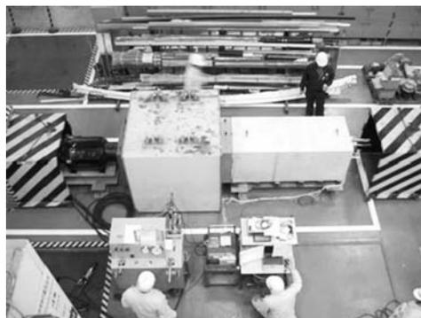
写真9 実大引張試験（於：住友電工伊丹製作所）
