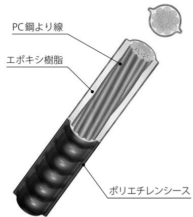
図3 プレグラウトPC鋼材の構造
