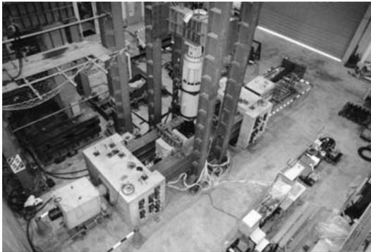
写真4 5,000kN級外ケーブルの実大疲労試験
