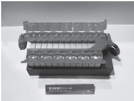
写真2 高圧バッテリーへの搭載イメージ (バッテリーは参考模型)
