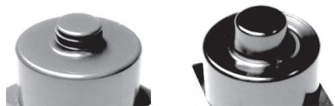
写真3 ネジ形状プローブツール（左）と円錐台プローブツール（右）
