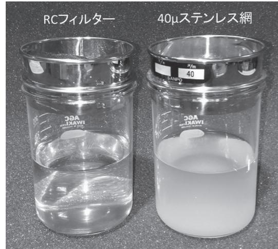
写真1 ステンレス網およびRCフィルター濾材の分離能
