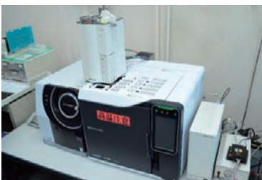
Py-GC/MS (熱分解ガスクロマトグラフ質量分析装置) Pyrolysis-Gas Chromatography/Mass Spectrometry
