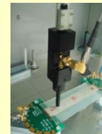
極細同軸シールド上の定在波
