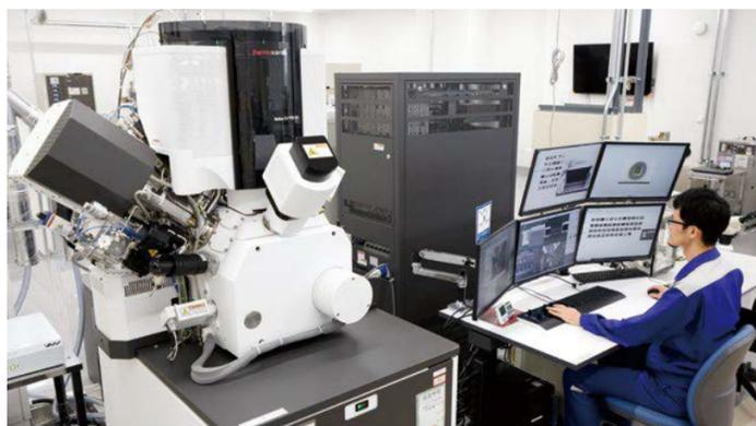
FIB-SEM / 集束イオンビーム・走査型電子顕微鏡複合機。断面加工・観察の主力設備
