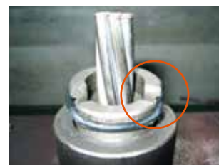
不具合のある装着状況 (オスコーン軸方向のずれ有)
