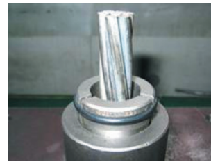
正常な装着状況 (オスコーンのずれ無)
