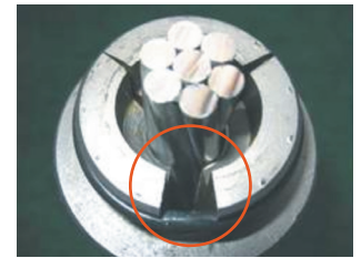
不具合のある装着状況 (オスコーン円周方向のずれ有)
