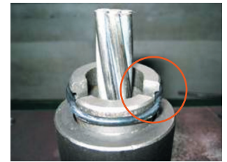
不具合のある装着状況 (オスコーン軸方向のずれ有)
