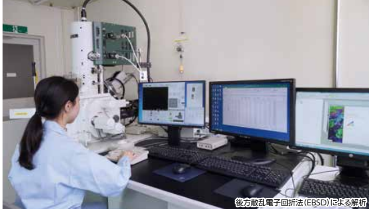
後方散乱電子回折法 (EBSD) による解析 Analysis by Electron Back Scatter Diffraction (EBSD)
