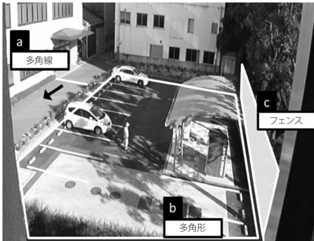
図4 駐車場におけるルール設定の一例 (a) 多角線で通路の人物移動を監視 (b) 多角形で駐車場内の不審者やしゃがみこみを監視 (c) フェンスを乗り越える不審者を監視
