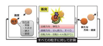
個別要素法(DEM)を用いた粉体粒子の 挙動シミュレーションのアルゴリズム(11)
