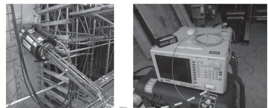
緊張用油圧ジャッキ 接続用光ファイバ 計測器
